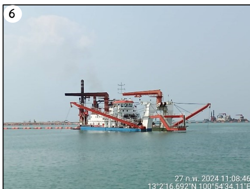
เรือขุดแบบ Cutter Suction Dredger
