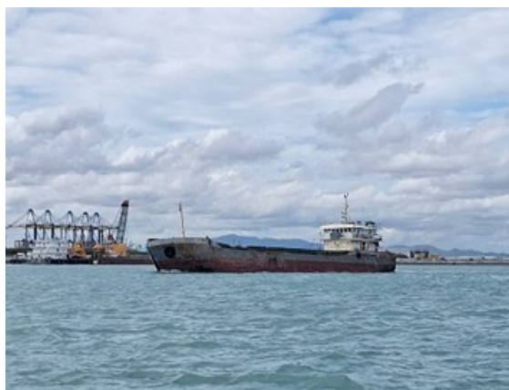
รูปที่ 2-4 : เรือแบบ Hopper Barge
