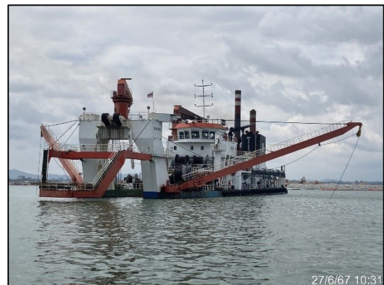
รูปที่ 2-38 : เรือขุดแบบ Cutter Suction Dredger
