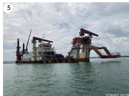
เรือชุดแบบ Cutter Suction Dredger
