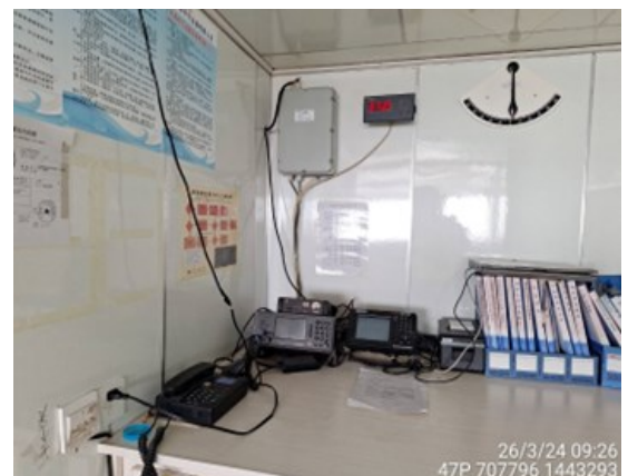
รูปที่ 2-5 : ระบบระบุตำแหน่งที่แม่นยำของเรือ ชุดลอก (GPS)
