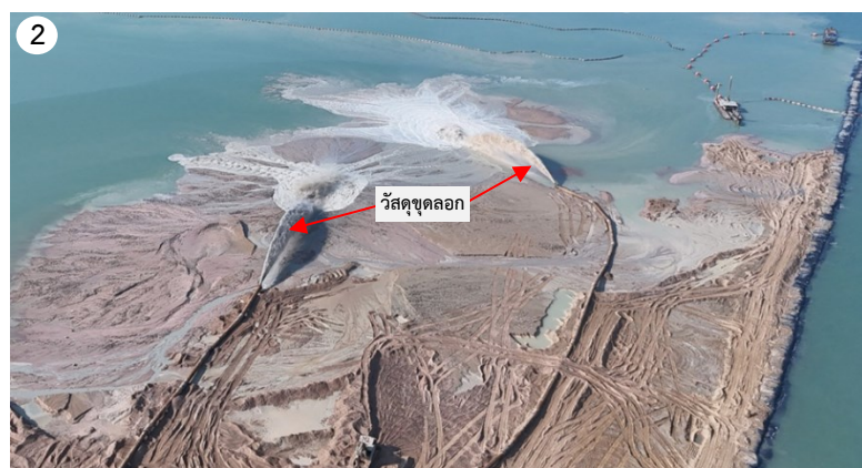
พื้นที่ถมทะเล F1 เพื่อนำทรายมาใช้สำหรับการก่อสร้าง Sand Geotube
